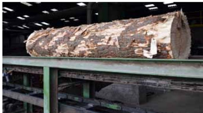
Calibrée et écorcée, la grume est acheminée vers la ligne de sciage.
