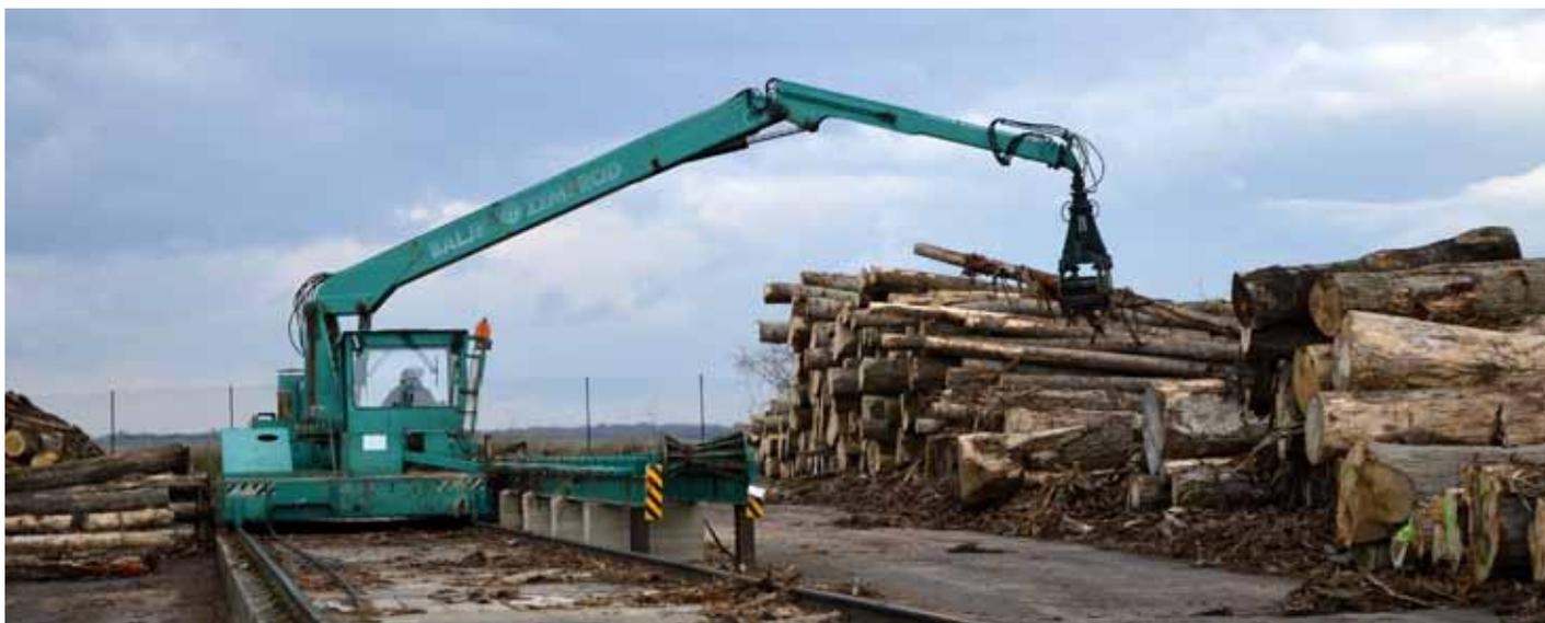
Dans la cour de la scierie, cette grue sur rails permet d'acheminer les grumes de la zone de stockage vers la ligne de production.
